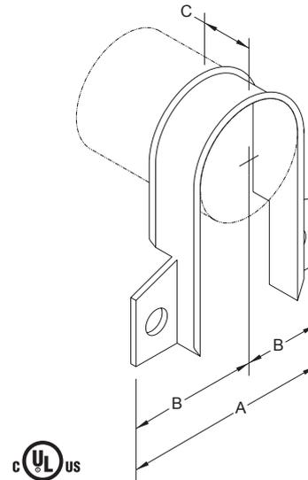
Rohrhänger für PVC-C Rohr
